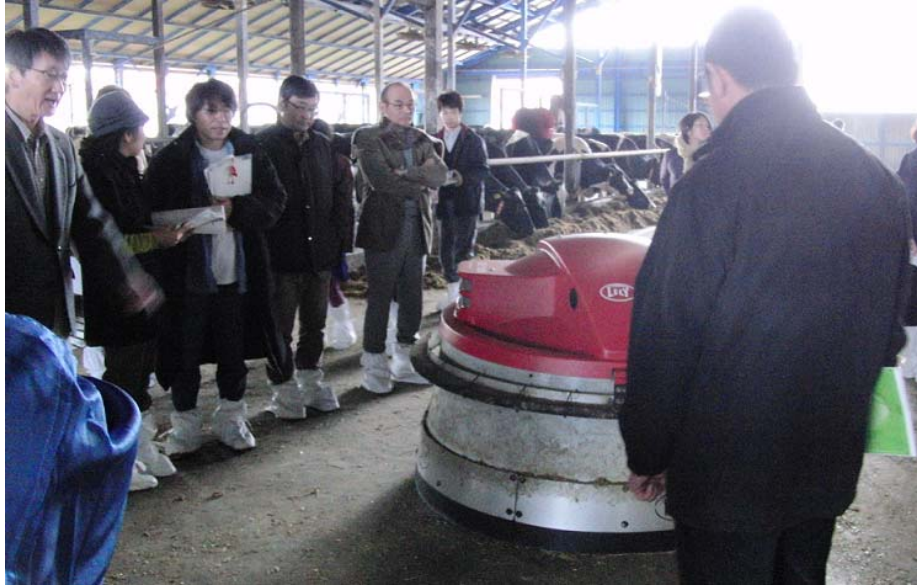
自動餌寄せ機が走行する様子を見守る
